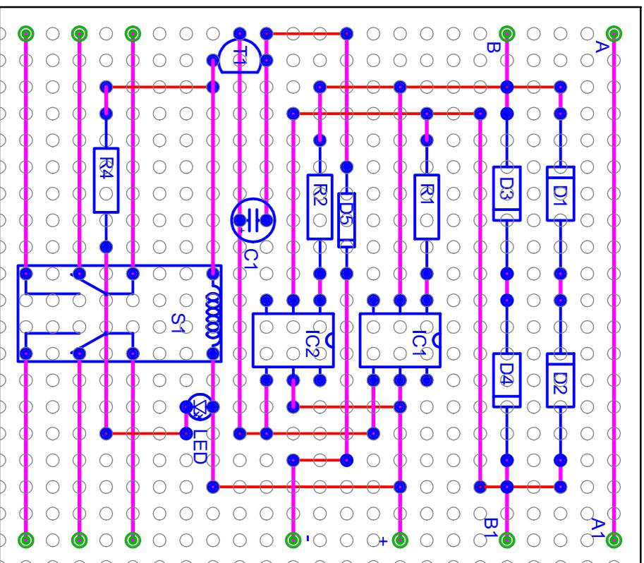
Durch Weglassen von R3 und C2 schaltet das Relais nun so lange durch, wie der Meldeabschnitt besetzt ist.
